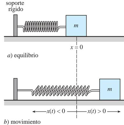
**Figura 3.63** Sistema deslizante resorte-masa para el problema 53
