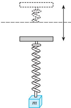
Figura 3.28 Movimiento vertical oscilatorio del soporte
