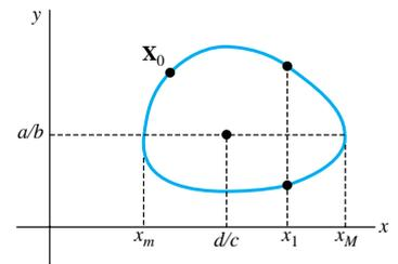
Figura 9.36 Solución periódica del modelo de Lotka-Volterra
