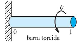
Figura 11.19 Calcule el ángulo de torsión  $\theta$
