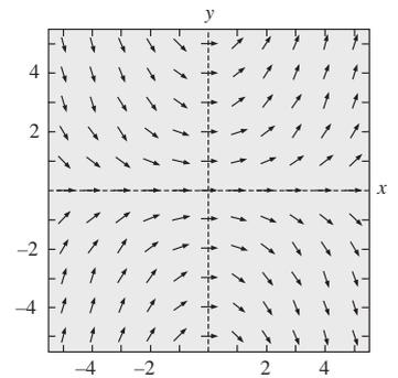
a) Campo de direcciones para  $dy/dx = 0.2xy$
