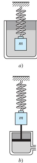
Figura 3.22 Dispositivos amortiguadores
