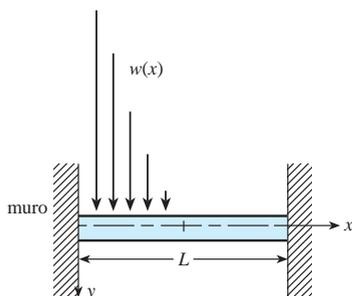
**Figura 4.17** Viga empotrada con una carga variable
