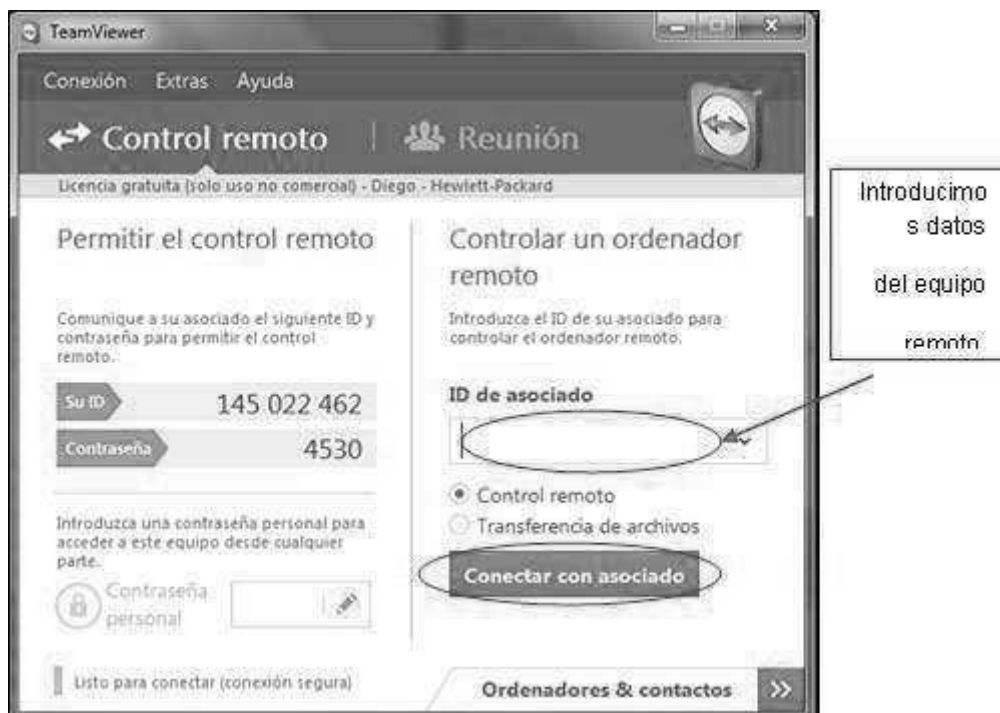
Figura 3. Introducción de datos para el control remoto del equipo asistido.
