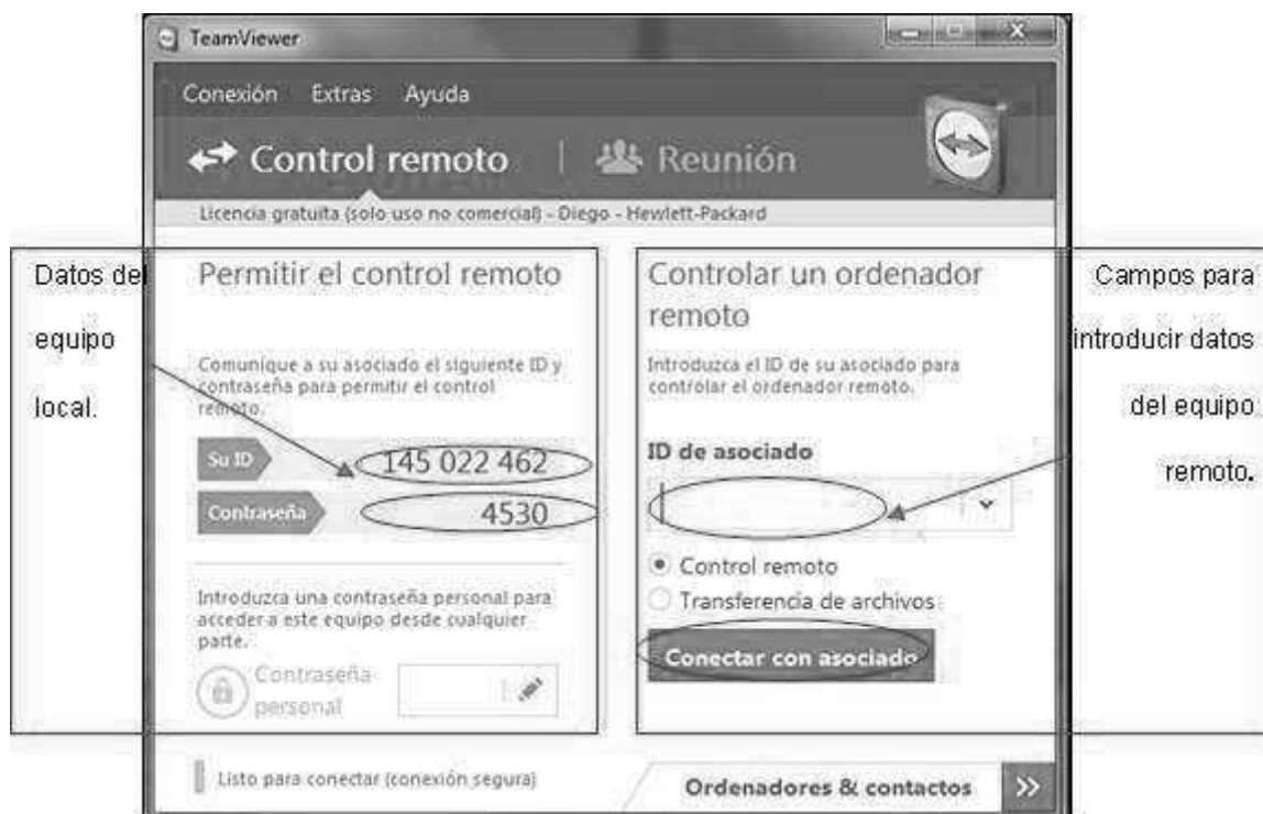
Figura 2. Datos para el control remoto de la aplicación Teamviewer.
