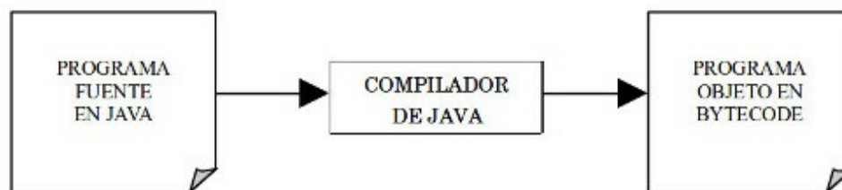
Fig. 4. El compilador de Java convierte el código fuente en código objeto para la máquina virtual de Java (bytecode).
