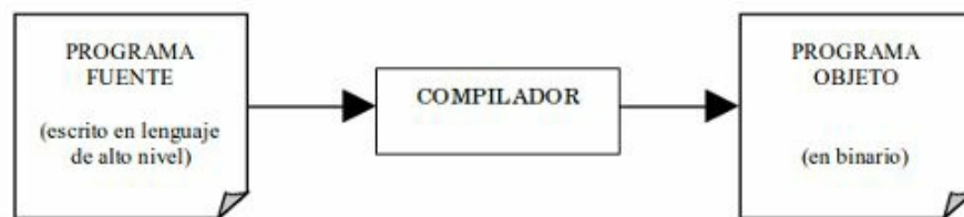
Fig. 2: El compilador traduce el lenguaje de alto nivel a código binario antes de la ejecución, produciendo un programa binario ejecutable.
