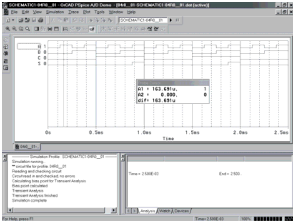
Figura 4.25. Resultados obtenidos en OrCAD PSpice A/D Demo para la puerta AND de tres entradas
