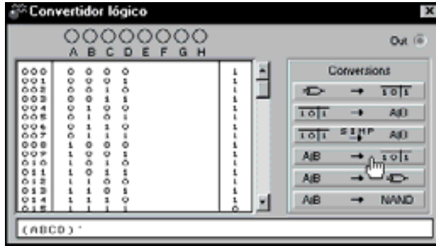
Figura 3.4. Comprobación de la ley de De Morgan (expresión [3.13]) introduciendo primeramente (A \cdot B \cdot C \cdot D)' en el convertidor lógico
