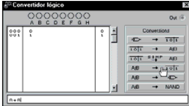
Figura 3.2. Comprobación de la ley de idempotencia (expresión [3.7]) introduciendo primeramente A+A en el convertidor lógico
