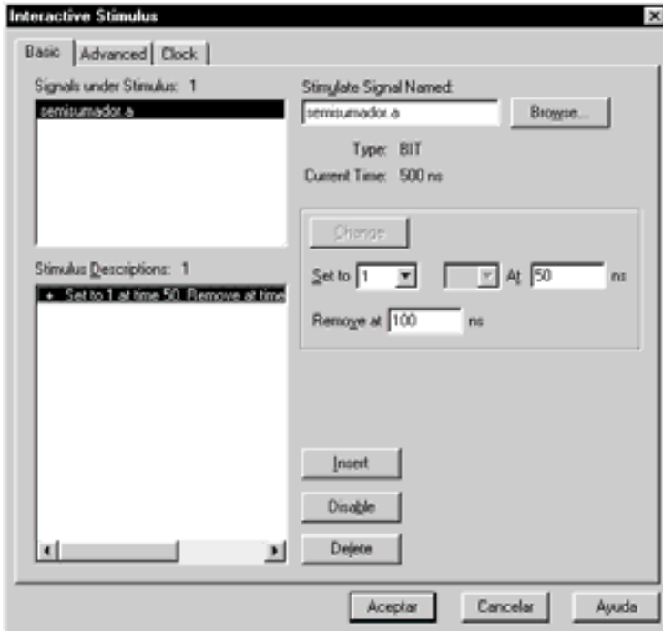
Figura D.17. Herramienta de generación de estímulos de tipo Basic
