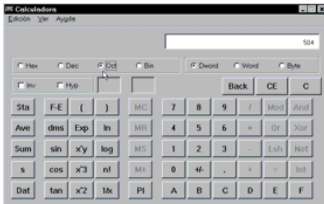
Figura 1.10. Conversión a octal del número decimal 324 utilizando la calculadora de Windows
