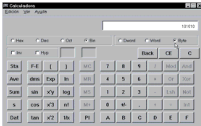
Figura 1.14. Obtención del número 42_{(10)} representado según el convenio del complemento a dos, mediante la calculadora de Windows
