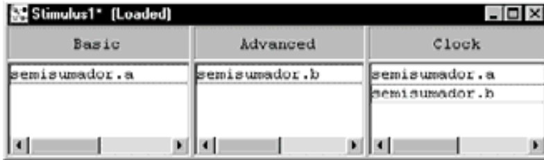
Figura D.23. Información de las señales de estímulos definidas mediante la herramienta interactiva del simulador y su tipo
