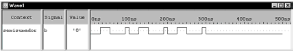
Figura D.20. Cronograma de la señal de entrada b definida de tipo Advanced
