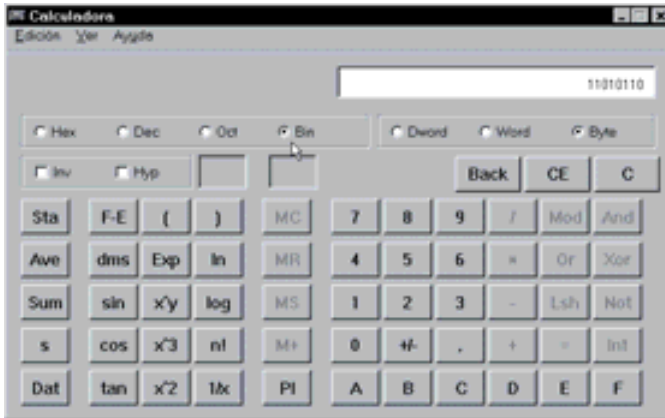
Figura 1.15. Obtención del número -42_{(10)} representado según el convenio del complemento a dos, mediante la calculadora de Windows
