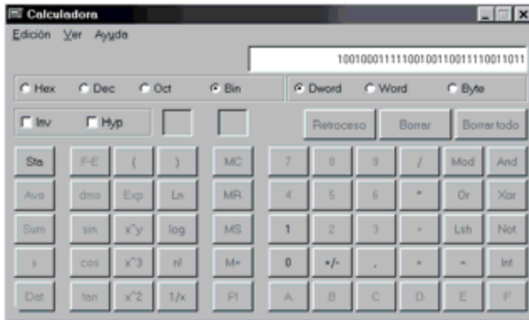
Figura 1.20. Conversión a binario, en convenio de complemento a dos, del número decimal -1846384741, utilizando la calculadora de Windows
