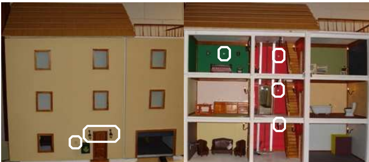
Figura 9: Instalación automatizada de iluminación. En blanco están destacadas las luces (LEDs de alta eficiencia) controladas directamente por el autómata
