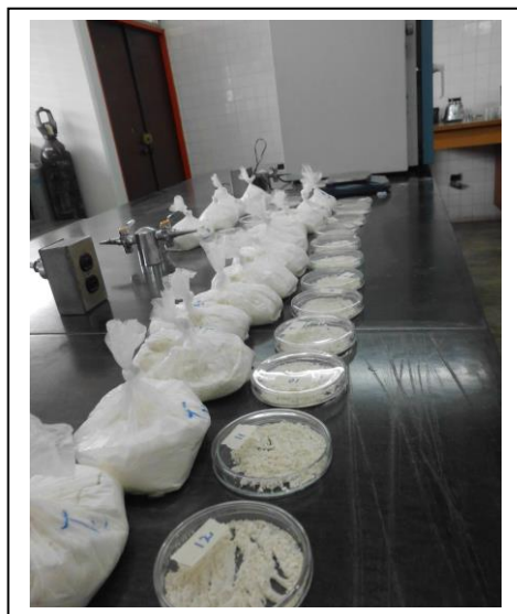
Determinación de humedad de mezcla óptima
