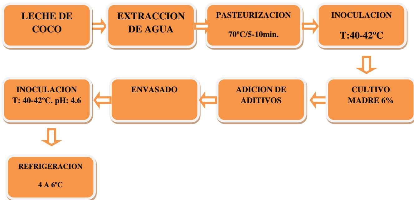
**Figura 2. Esquema tecnológico de elaboración de postre fermentado**
