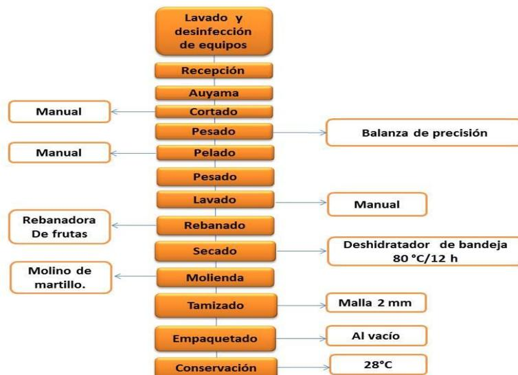
Figura N° 2. Esquema adaptado al LITA para la obtención de harina de auyama.
