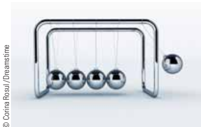
Figura 6-1 El aparato con bolas que chocan demuestra la conservación del momento y la energía cinética.
