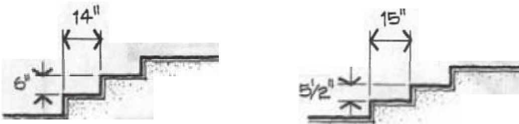
FIGURA 10-11 Ejemplos de relaciones ideales de huellas/contrahuellas.
