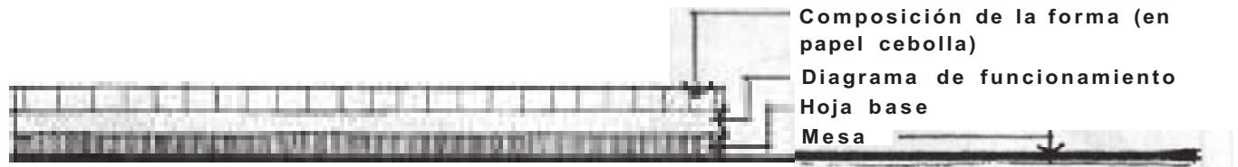
FIGURA 9-78 Un sistema de calca sucesiva se debe usar para desarrollar la composición de la forma en relación con el diagrama de funcionamiento.
