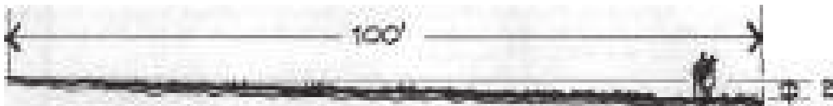
Pendiente mínima preferida para drenaje positivo de un césped
