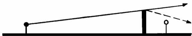
13.23. El efecto de barreras para el ruido. La peor posición es a la mitad de la distancia entre la fuente y el oyente.
