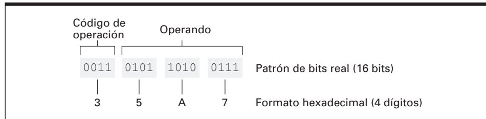
Figura 2.5 Composición de una instrucción para la máquina del Apéndice C.
