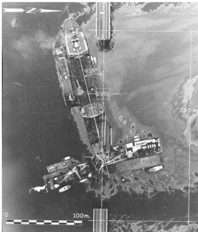
Figuras 5. Tanquero entre pilas. Fotografía vertical del tanquero entre las pilas 30 y 33 tomada desde 280 m de altura con un helicóptero en posición estable.
