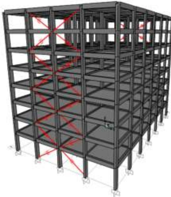
Fig. 3.1 Ubicación de los disipadores en la Dirección X (Vista 3D)
