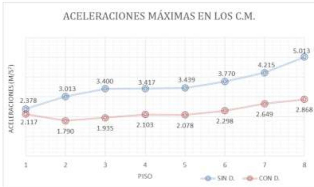
Fig. 4.7 Comparación de las aceleraciones máximas en los C.M.
