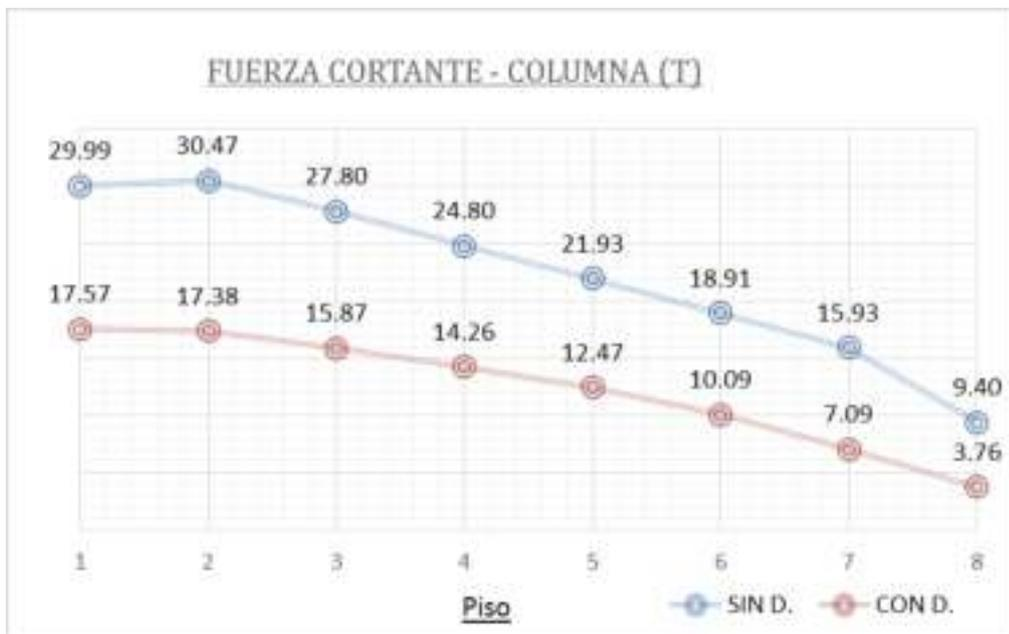
Fig. 4.5 Fuerza cortante máxima en cada piso para la columna seleccionada
