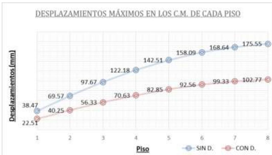
Fig. 4.1 Desplazamientos máximos absolutos en los C.M. de cada piso (Dirección X-X)
