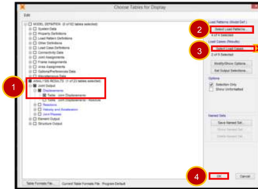
Seleccionaremos el tipo de desplazamiento que deseamos obtener, en X (COMBESPX), en Y (COMBESPY) o desplazamientos modales (MODAL)
