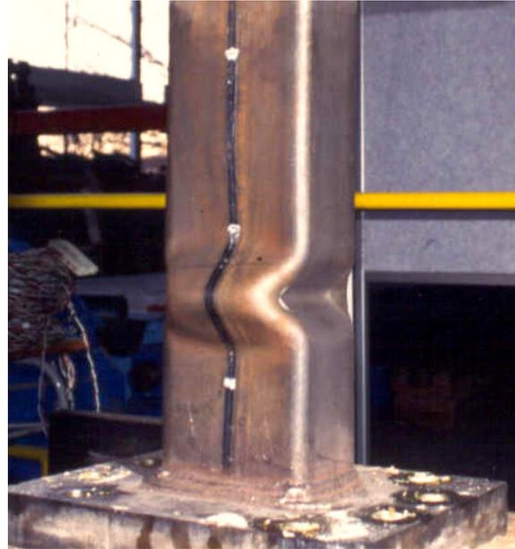
Fig. 1-4. Pandeo local en un tubo de acero sometido a compresión.
