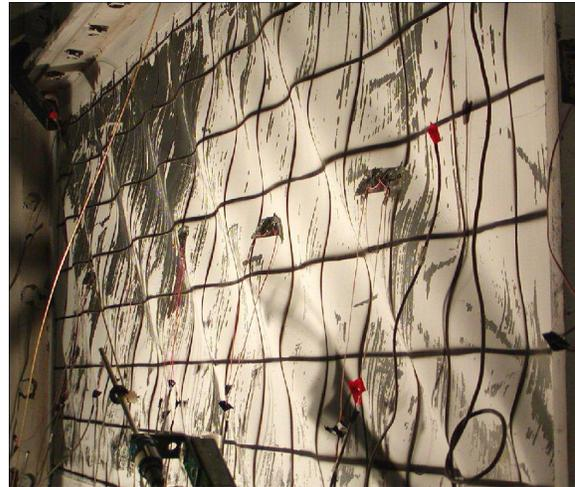
Fig. 2-17. Vista de la placa de acero, con clara evidencia de fluencia y pandeo, en ensayos realizados por Berman y Bruneau (2003).
