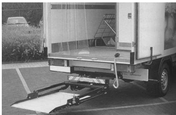
(Figura 14.14) Furgoneta con rampa hidráulica
