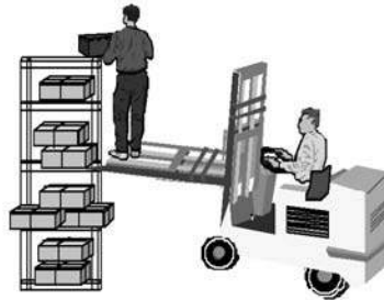
(Figura 7.13) Extracción manual, carretilla + 2 personas
