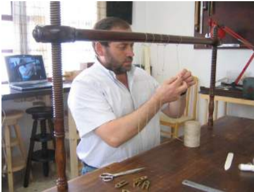
Colocación de las cuerdas
