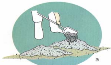
3 En el mezclado a mano se utilizará un tablero o un piso de concreto.
