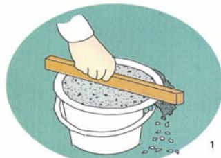
1 Medida de los materiales: agua, piedra y cemento.
