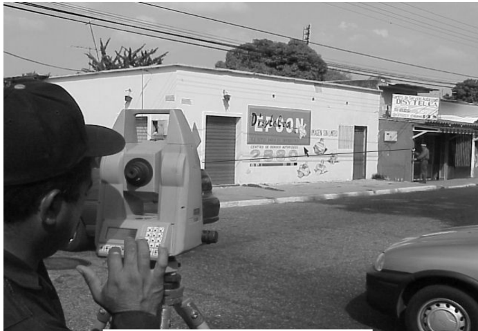
Estación Topográfica Total
